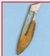
Rez na čepelce skalpelu. Příčina: materiál, nejedná se o nerezovou ocel, výrobek pro jednorázové použití
