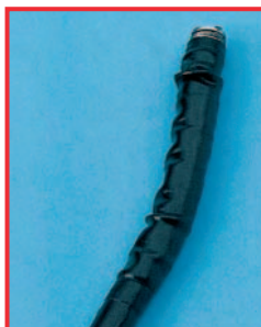
Zpuchření na hadici fibroskopu při použití nesprávné konzervační látky
