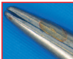
Plošná koroze jehelce působením kyseliny v místě kontaktu pájky a tvrdokovové vložky Těžké opotřebování stejně jako poškození Příčina: předávkování
