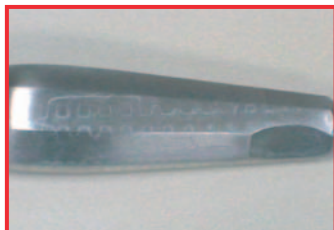
Zanesení zbytky dezinfekčního prostředku při nedostatečném propláchnutí
