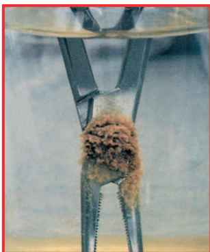
Vytvoření rzi při vícehodinovém ponoření do fyziologického roztoku
