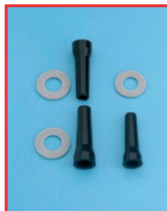
Zpuchřelé těsnění jako následek použití nevhodného nástrojového oleje
