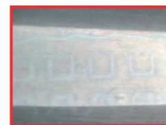
Povrch nástroje s otiskem perforace síta
