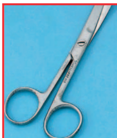
Nůžky s důlkovou korozí
