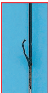
Poškozená izolace na VF nástroji
