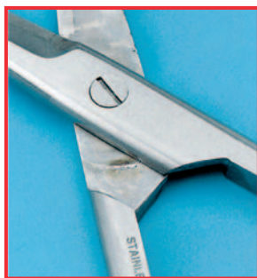
Koroze z oděru, způsobená neodpovídajícím promazáním olejem
