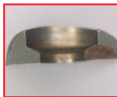
Plocha lomu ve vyhloubení otvoru pro hlavu šroubu
