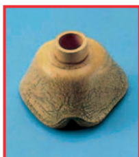
Trhlina a poškození povrchu vysokou teplotou při sušení
