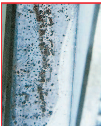
Usazeniny leptavého prostředku obsahujícího chloridy na nástroji
