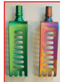
Levá valva: zcela nová - stejnoměrně zelená. Pravá valva: čištěná strojem
