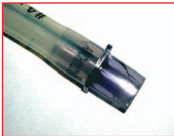
Trhlinka způsobená pnutím
