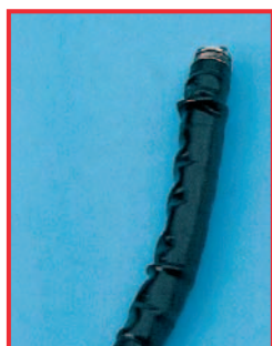
Nabobtnání na distálním konci fibroskopu
